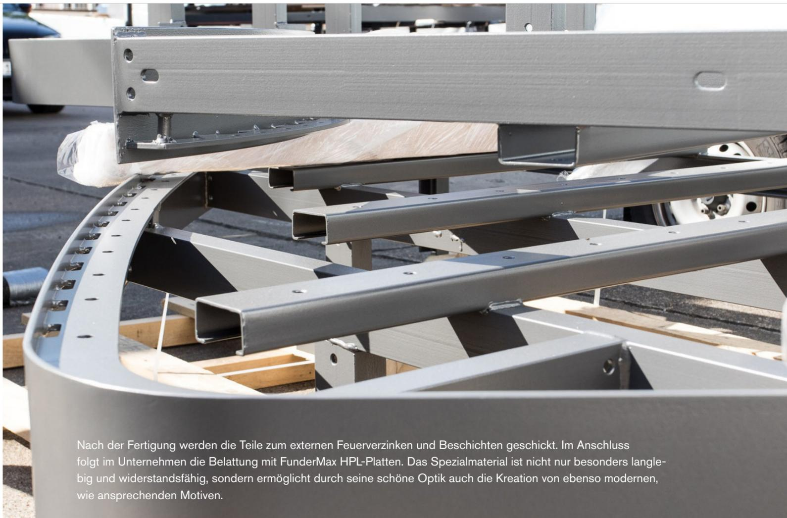
Nach der Fertigung werden die Teile zum externen Feuerverzinken und Beschichten geschickt. Im Anschluss folgt im Unternehmen die Belattung mit FunderMax HPL-Platten. Das Spezialmaterial ist nicht nur besonders langlebig und widerstandsfähig, sondern ermöglicht durch seine schöne Optik auch die Kreation von ebenso modernen, wie ansprechenden Motiven.
