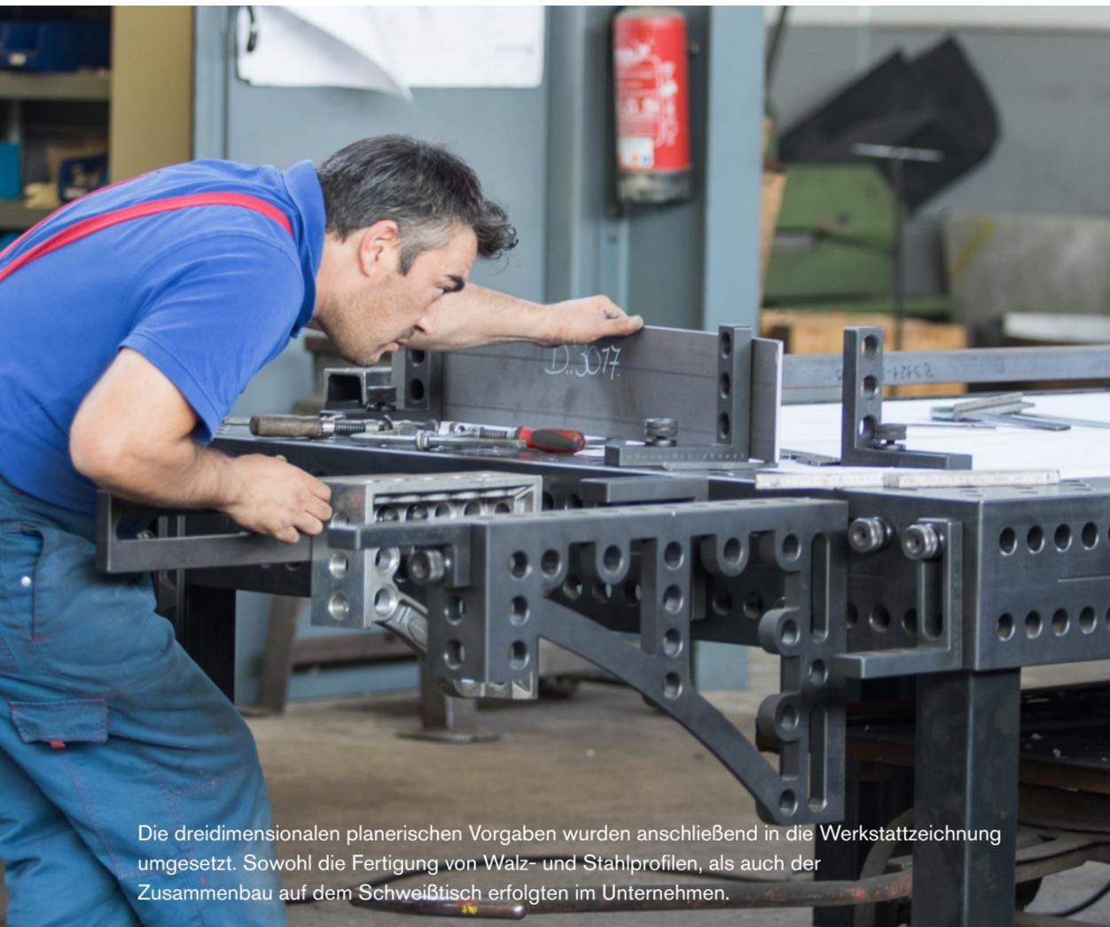
Die dreidimensionalen planerischen Vorgaben wurden anschließend in die Werkstattzeichnung umgesetzt. Sowohl die Fertigung von Walz- und Stahlprofilen, als auch der Zusammenbau auf dem Schweißtisch erfolgten im Unternehmen.
